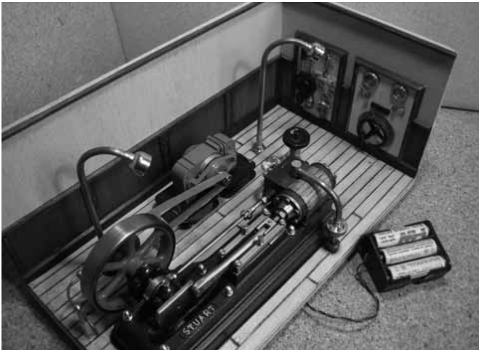
Abb. 1: Versorgung der elektrischen Anlage mittels Akku
