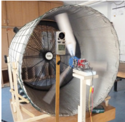
Abb. 2: Windmaschine, offener Windkanal, Messgerät für Windgeschwindigkeit
