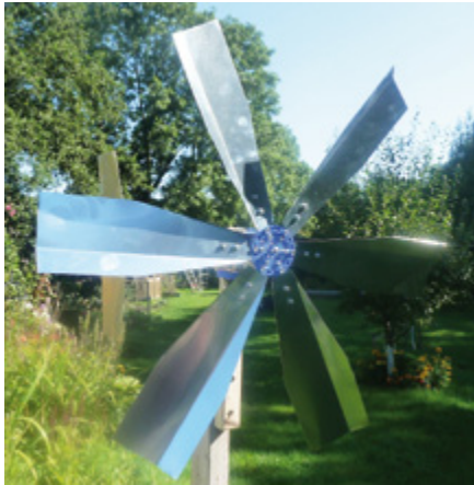
Abb. 9: 6-Blatt-Rotor, vergrößerte Wind-Angriffsfläche
