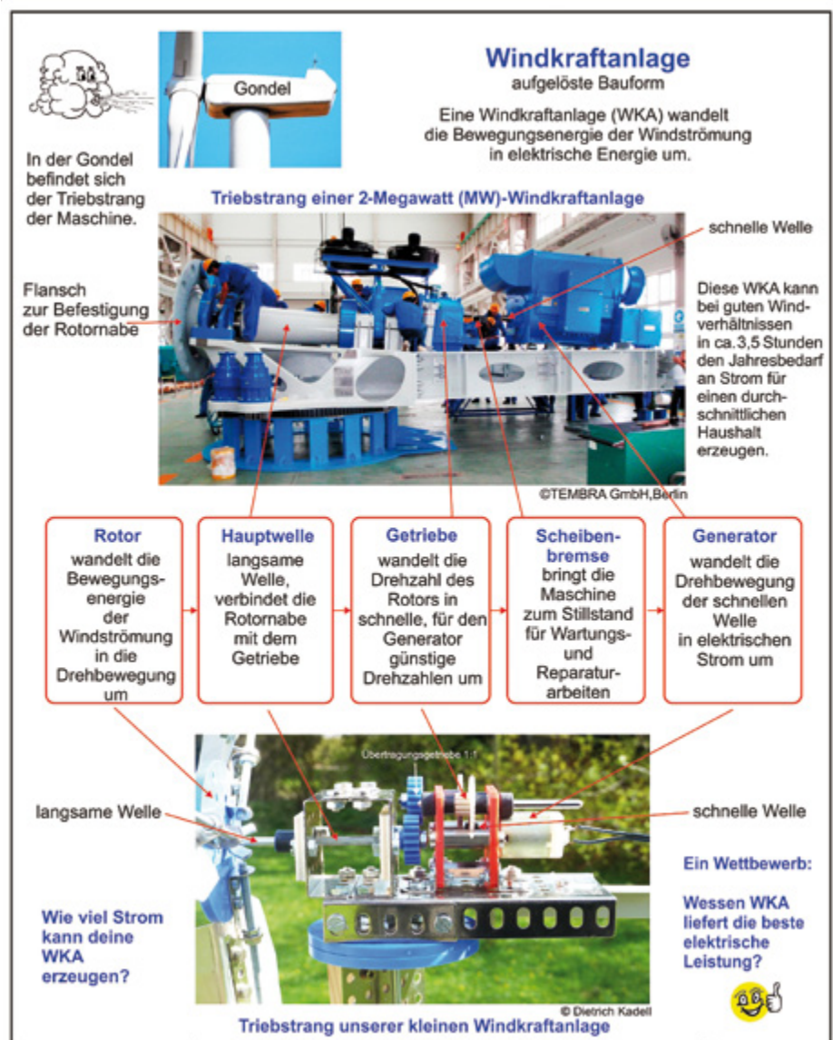
Abb. 1: Triebstrang, moderne WKA und Funktionsmodell
