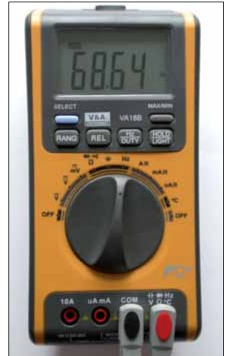
Digitalmultimeter, für eine Drehzahlmessung geeignet Frequenzanzeige momentan: 68,64 Hertz (Hz). 1 Hz entspricht 1/s oder 1 (Wechsel) je Sekunde.
