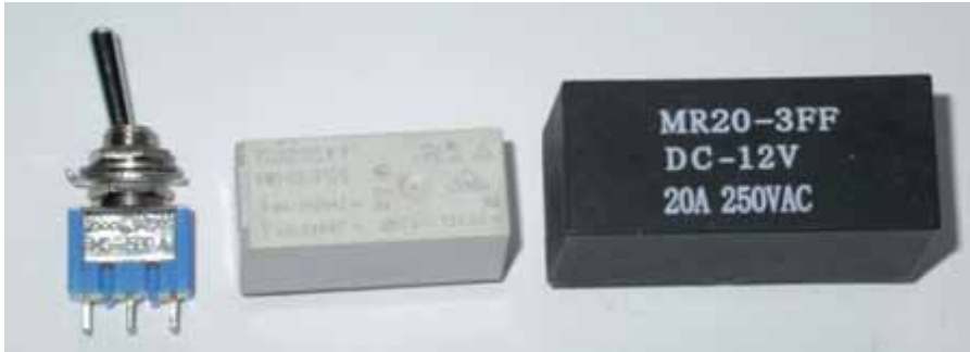
Die Umschalter: 1x UM (manuell), 2x UM (Wechsler-Relais), Motorumpol-Relais (Spulenspannung 12 V, Kontaktspannung zwar bis Netzspannung möglich, aber im Unterricht für Schüler/-innen nur bis 24 V gestattet)
